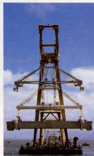
La construcción de la barrera anti-tempestad requirió el diseño y construcción de barcos no usuales. Vistas del Ostrea, Macoma y Taklift
